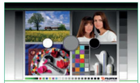
**REFERENZ** Vier Motive und Messfelder für eine umfassende Bildanalyse. Die einzelnen Messfelder haben definierte Werte für die messtechnische Auswertung. Alle Charts: Fujifilm/Jens Rubbert.
